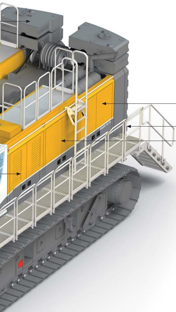
Leistungsstarke und wirtschaftliche Dieselmotoren mit hoher installierter Leistung zum gleichzeitigen Betrieb mehrer leistungsintensiver Funktionen (z. B. CAT C 18 mit 563 kW – Tier 4 final)
