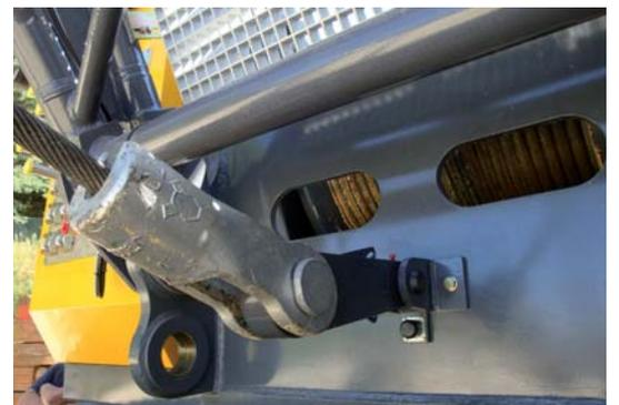
Seilfestpunkt mit Überlastsicherung und Notabschaltung
