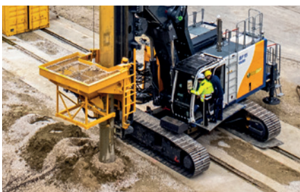
BF 15 mit TR 17 K (RSV) (Beschickungseinheit) BF 15 with TR 17 K (VR) (Transport hopper)
