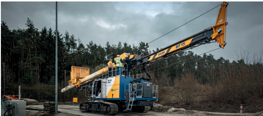
BF 15 mit TR 17 K (RSV Tiefenzufuhr) BF 15 with TR 17 K (VR Bottom Feed)
