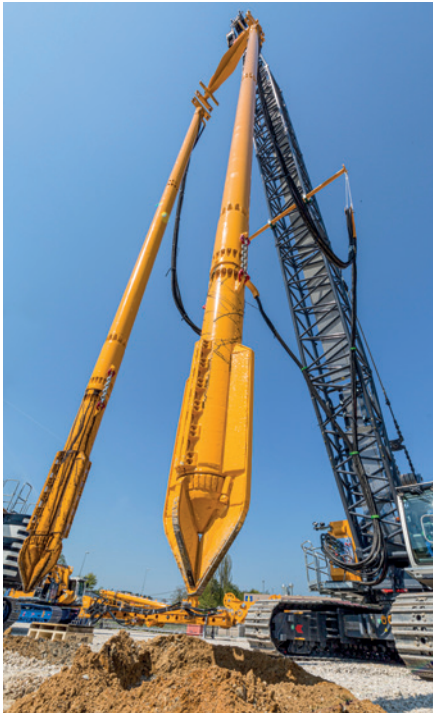
MC 96 mit Tandem Rüttler TR 75 (RDV) MC 96 with tandem vibrator TR 75 (VC)
