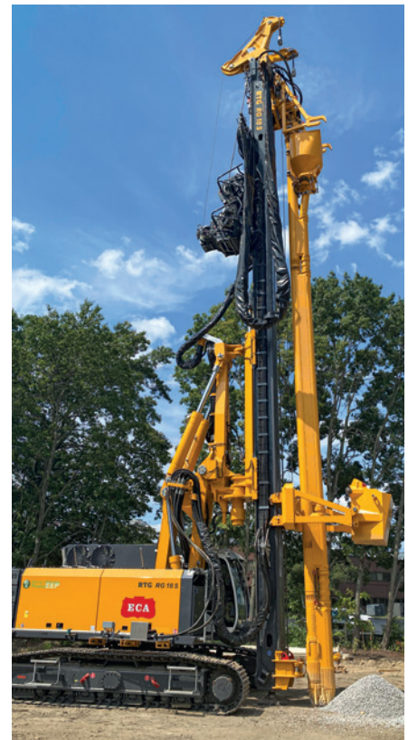
RG mit TR 17 S (RSV Tiefenzufuhr) RG with TR 17 S (VR Bottom Feed)
